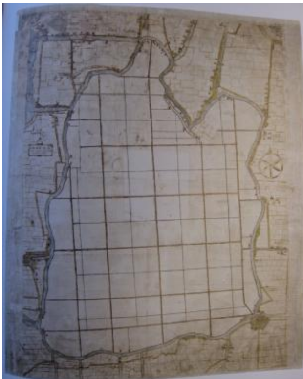
(afb. 3 III.12. Steenbergen, 2009. Ontwerptekening uit 1611 van Gerrit Dirksz. Langedijk van de droogmakerij De Beester in 1612 drooggemalen. Het systeem 'poldermodule', door Stevin ontwikkeld, is goed te herkennen)
