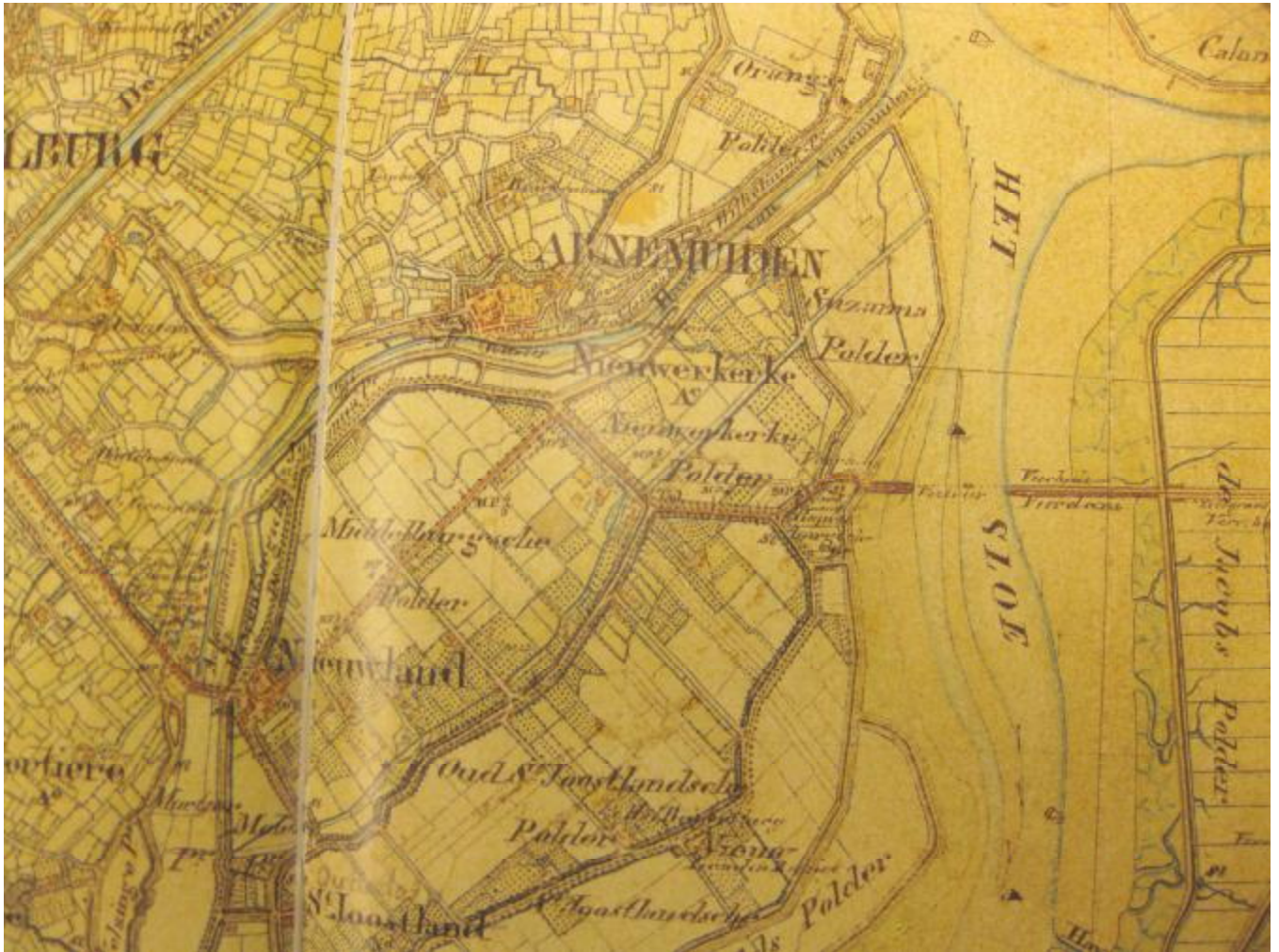
(afb. 3 II.12, Grote Historische Provinciale Atlas Zeeland 1856-1858 . 1856 . Nieuwland. In de Zaagmolenpolder zijn nog gebouwen en balkhavens te onderscheiden. De kavels, veelal met bomen beplant, zijn groter en rechthoekiger dan de kavels van het Walcherse oudland. De wegen zijn rechter. De dijken zijn beplant. Het Arnemuïdsche Gat is afgedamd en binnenhaven geworden. De Mortierepolder is ingedijkt. In de Rapenburgerpolder functioneren nog het Sloeveer en het Veerhuis. De kreklopen zijn te zien. De ontsluitingswegen zijn niet uitgebreid t.o.v. oudere kaarten)
